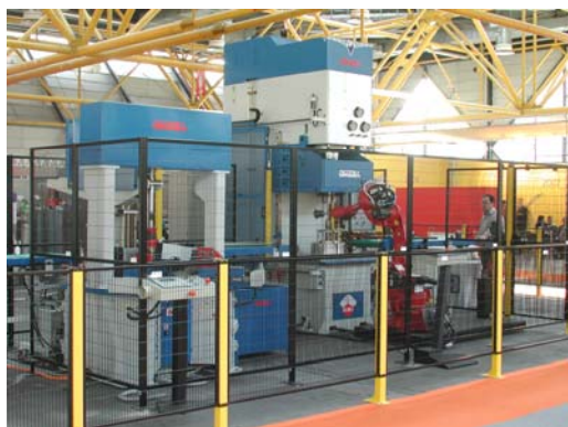
図2. 防護柵と統合生産システム
